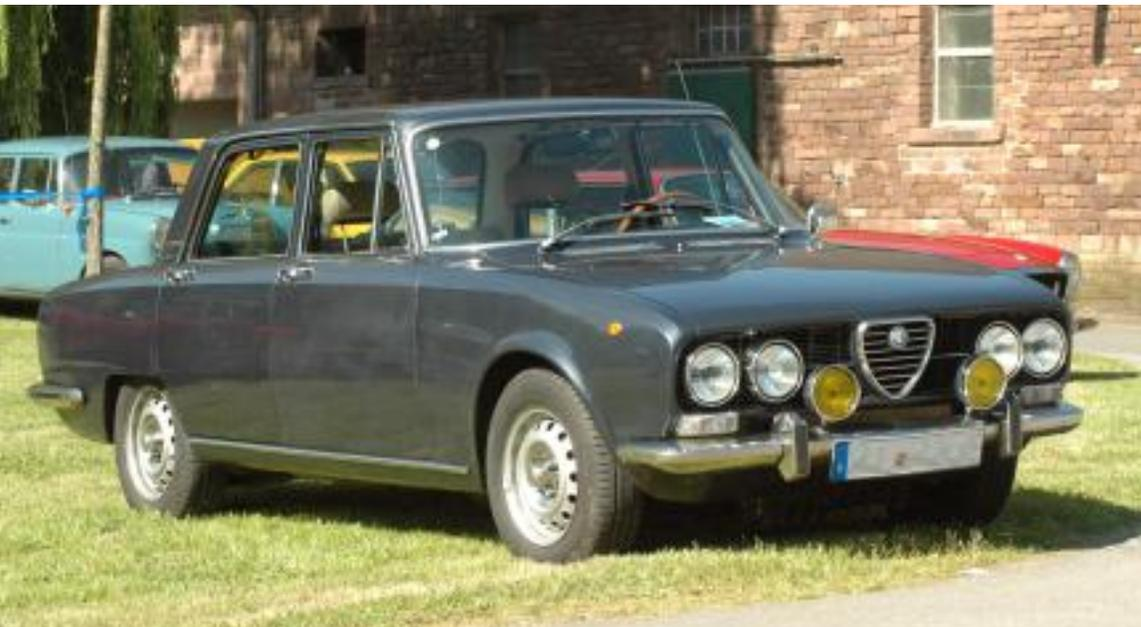
Er besitzt einen 4-Zylinder-Reihenmotor (Viertakt), der mit 1962 ccm 150 PS leistet. Das maximale Drehmoment liegt bei 3500 Umdrehungen/Minute bei 215 Nm. Sein Leergewicht liegt bei 1.100 kg und er erreicht eine Höchstgeschwindigkeit von 190 km/h. Sein Verbrauch liegt bei 12,1 Liter/100 km, sein Preis bei 14.890 DM.
