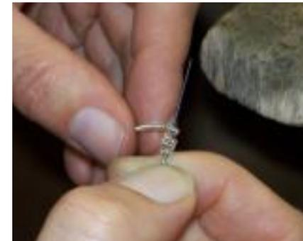
einem Messerdraht, dessen obere schmale Kante etwas sehr feines Dünnes assoziiert. Die Höhe des Materials gibt dem ganzen jedoch genug Stabilität, dass es nicht so leicht verbogen werden kann.
