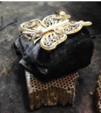
ner kleinen runden Platte aufgelötet, bevor es dann von hinten wiederum auf den Schmetterlingsflügeln aufgelötet wird.
