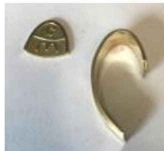
zu einer Zarge gefertigt, die nach seitlich unten hin etwas weiter wird. Diese wurde unter das Logo gelötet und der Übergang glattgefeilt.
