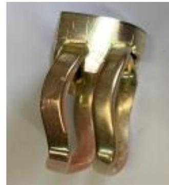
Zur Stabilisierung wurden noch zwei Stege in den unteren Bereich des Ringes eingearbeitet.
